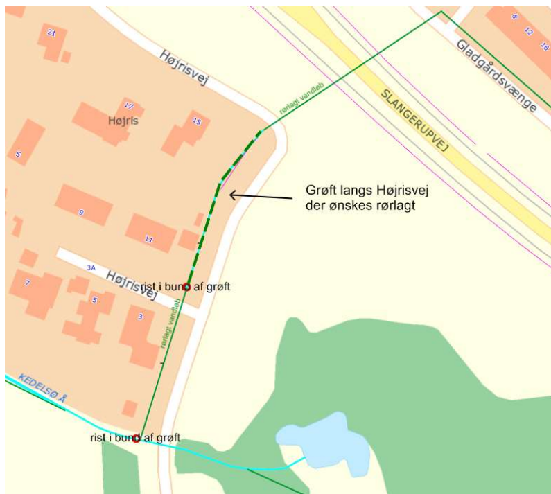
Figure 1. Skærmbillede der viser et udsnit af lokalområdet ved Højrisvej. Grøften der ønskes rørlagt er beliggende syd for Slangerupvej og parallelt med Højrisvej 11-15. Grøften er på kortet markeret med grøn stiplede linje.
